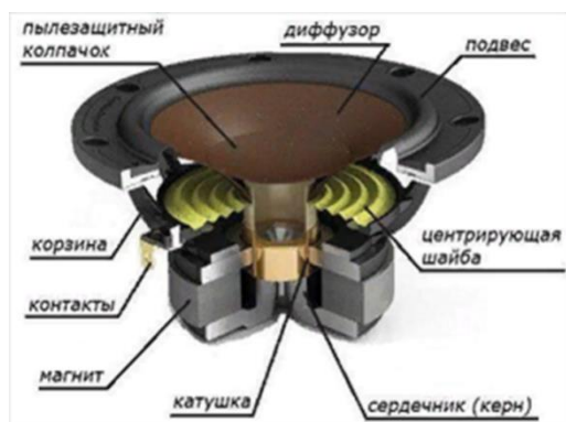
Рис. 4. Устройство динамика
